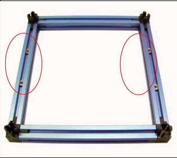
192mmフレーム4本とトリポイント4つを用いて底面フレーム枠を作ります。その際、フレーム2本に座金(1S)を2枚ずつ挿入しておきます。(左図参照)
